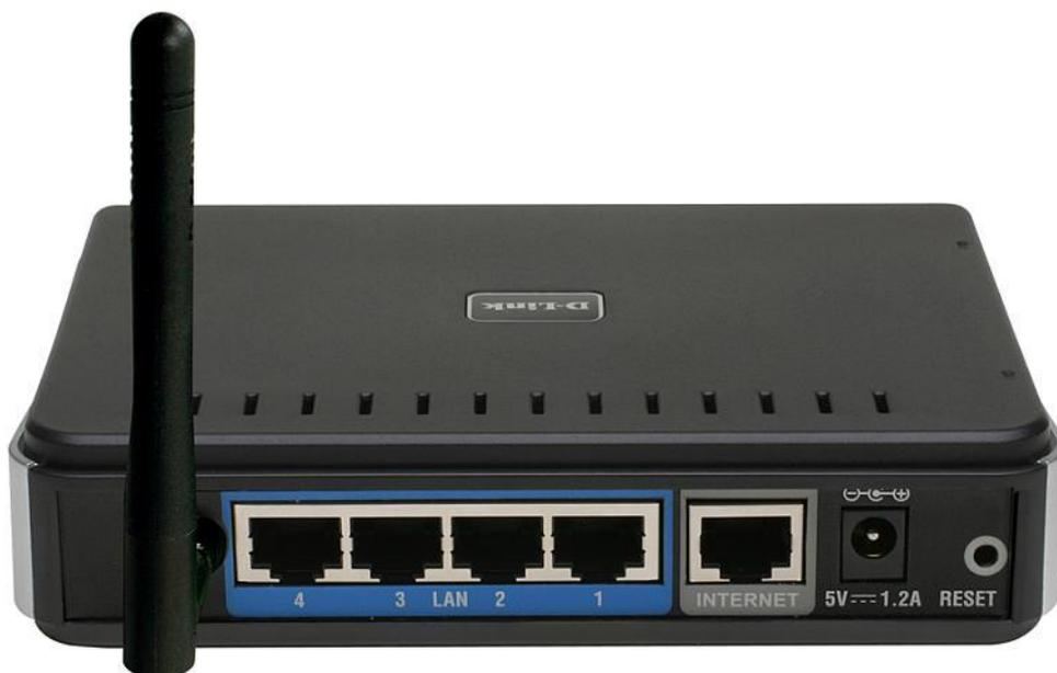
Подключите Ethernet-кабель Вашего FTTB-подключения к разъему **INTERNET (WAN)** – в некоторых моделях). Для подключения к компьютеру возьмите прилагаемый к роутеру Ethernet-кабель и подключите его одной стороной к одному из разъемов «LAN» на задней панели роутера, а другой стороной к аналогичному разъему на задней панели Вашего компьютера.
